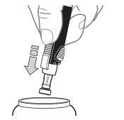
5. Die Verschlusskappe wieder anbringen und verriegeln. Zum Verriegeln den weißen Bund drehen.
